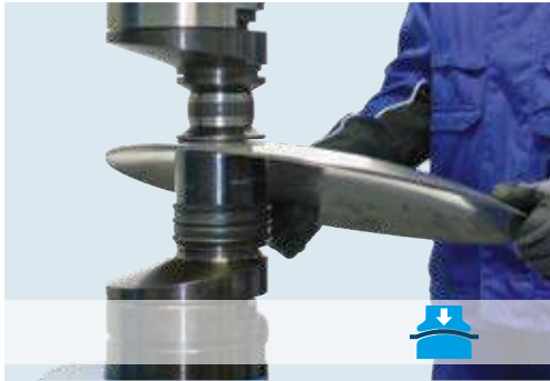
Wölben (Bombieren) von Blechen / Doming sheet metal
