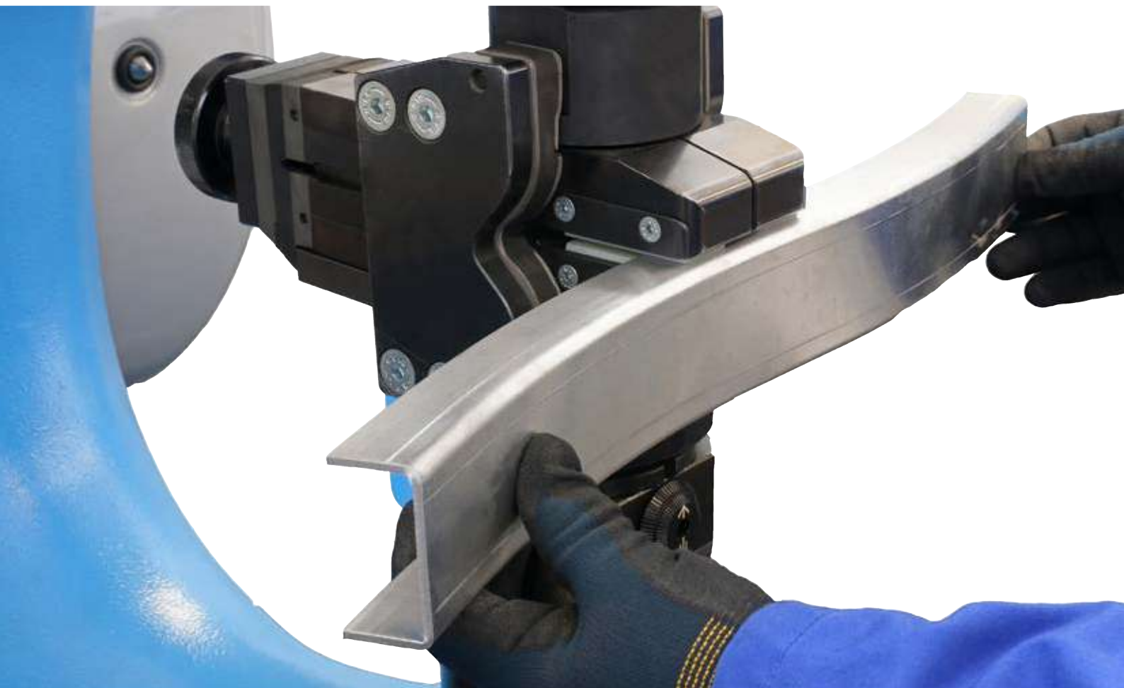
Stauchern und Strecken an U-Profilen / Shrinking and stretching on U-profiles
